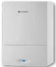
Modelo de 28 kw para agua caliente sanitaria ( ACS ) y 22kw en calefacción. Sistema QuickTap de preaviso de demanda. Con la apertura unos segundos de un grifo se avisa a la caldera de la necesidad de producir agua caliente ofreciéndole máximo confort y rendimiento optimizando más el consumo energético.
