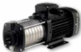
La serie CM3 y CM5 A de Grundfos son bombas centrífugas horizontales con aspiración axial y descarga radial. Sumamente compactas y silenciosas. El diseño de su cierre mecánico garantiza una resistencia especial a los riesgos de funcionar en seco mientras que sus motores de clase IE3 son sinónimo de un alto rendimiento energético. Las bombas CM3 y CM5 son perfectas para funcionar en carga.
