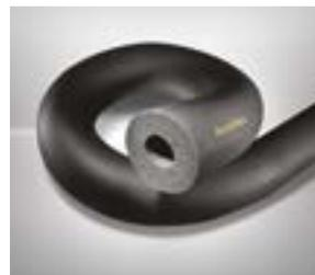
Aislamiento térmico flexible de célula cerrada, resistente a la difusión del vapor de agua y baja conductividad térmica. Espuma elastomérica basada en caucho sintético. Fabricada conforme a la Norma EN 14304.
